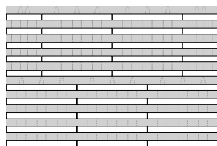
zatravnovací díl 42 mm tloušťka 12 cm
